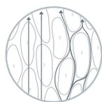
6種類の広帯域周波数(1kHz、5kHz、50kHz、250kHz、500kHz、1000kHz)を用いて細胞内水分と細胞外水分を分けて測定する技術です。交流電流は周波数によって細胞膜を透過する程度が異なります。InBodyはこの特性を利用して低周波の電流では細胞外水分を求め、多周波の電流では水分均衡と全体の体水分を求めます。
