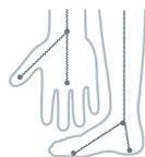
人体の形状を考慮して左右の手と足に各2個ずつの電流・電圧電極を配置し、計8個の電極を使用する技術です。電流と電圧を分離したInBodyの電極接触方式は、手首と足首の常に一定な位置から測定が始まるため、再現性がとても高く、皮膚による接触抵抗の影響が受けにくい正確な測定が可能です。
